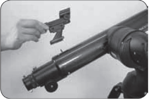
图 2-13 SkyProdigy70 安装寻星镜
