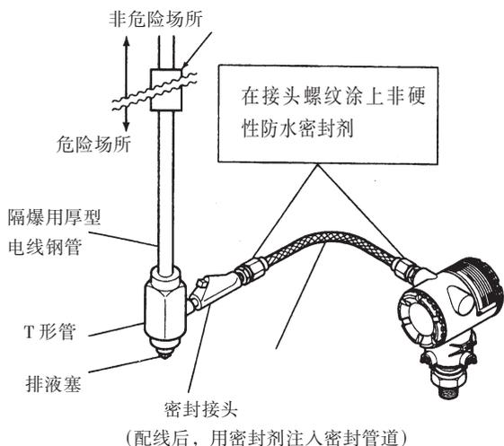
图 6.4.2c 用隔爆金属导线管的典型配线
