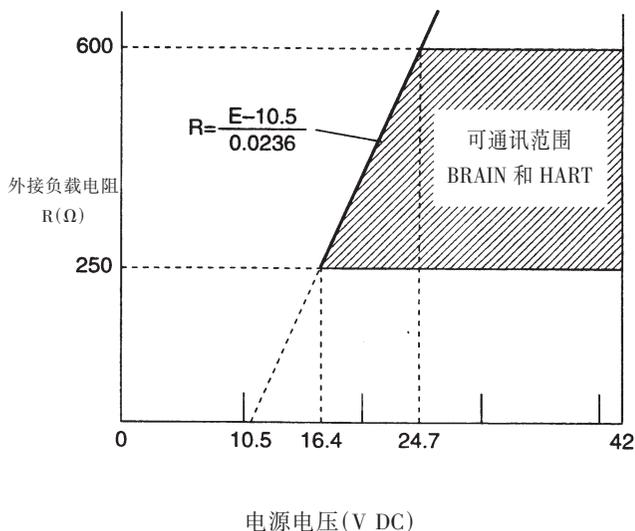
图 6.6 电源电压与外接负载电阻之间关系
