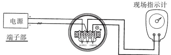
图 6.3.2 外接指示计连接
