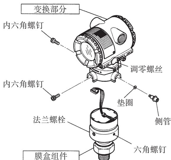
图 9.4.2 测压部的安装与拆卸
