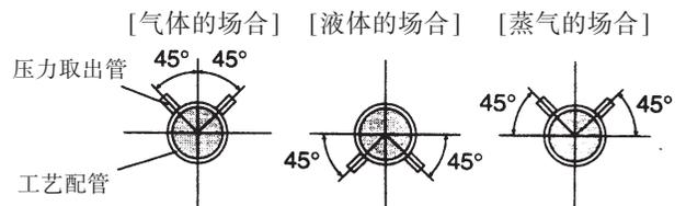
图 5.1.2 过程压力的引入角度(水平配管)
