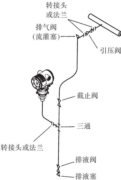
图 7.1 液体流测量(表压变送器)
