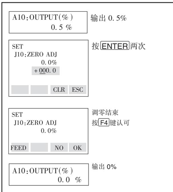
b 在测量罐体液位时, 如果实际液位不能变到 0 来进行调零, 可将输出调整到一个与实际液位值相应的参考值, 这个实际淤值可通过玻璃柱位读出。
