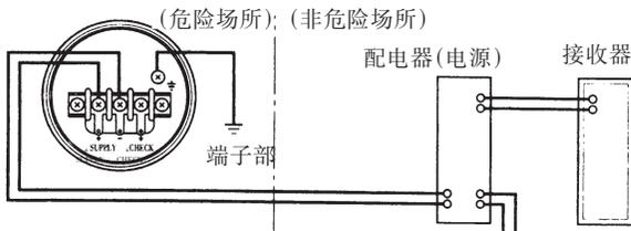
图 6.4.1a 变送器与配电器的连接
