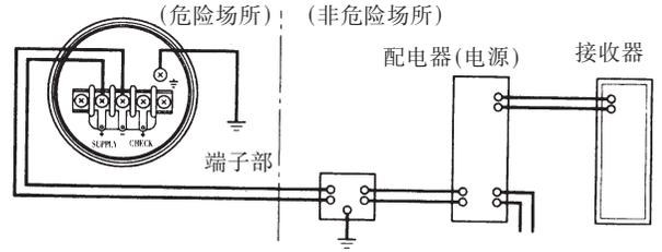
图 6.4.1b 变送器与配电器的连接
