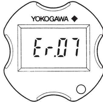
图 8.5.1 用内藏指示计检查故障
