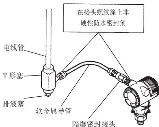
图 6.4.2b 用隔爆密封接头的典型配线
