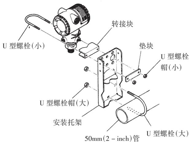
图 4.2.1 变送器安装
