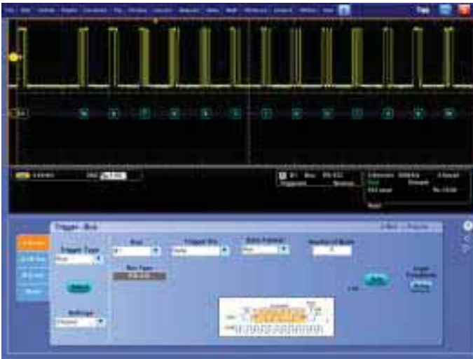
擷取 — 觸發整個 RS-232 匯流排的特定傳輸資料封包。完整的觸發功能，包括觸發特定串列封包內容，確保您能迅速擷取到感興趣的事件。
