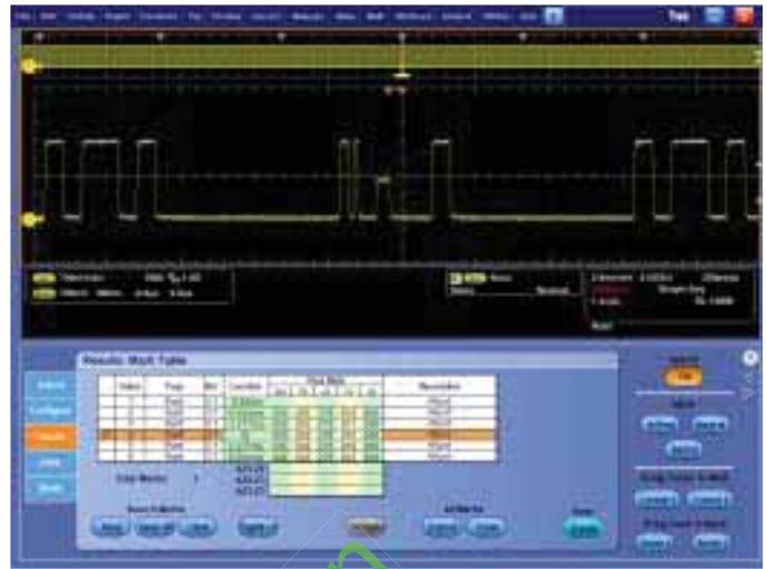
搜尋 — 長波形記錄內的矮波脈衝進階搜尋結果。為方便參考，每個矮波實例都自動加上標記。Wave Inspector 控制在檢視、瀏覽波形資料方面，提供了前所未有的效能。
