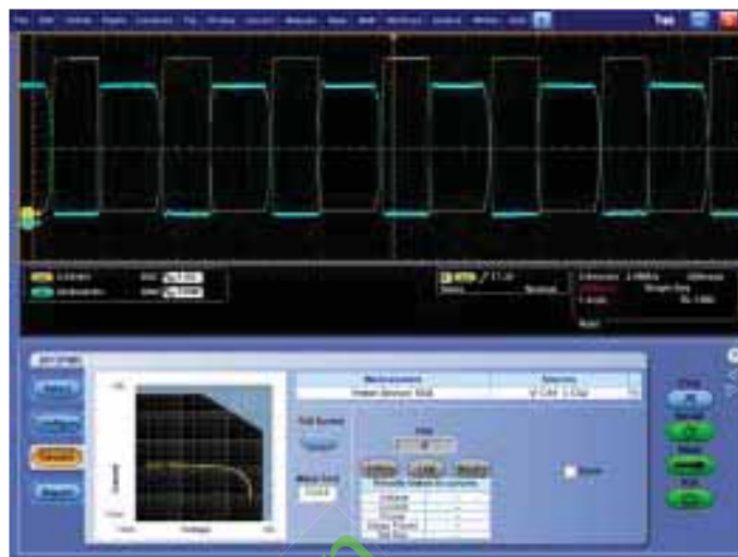
安全工作區量測，自動化功率量測能夠快速準確地分析常用功率參數。
