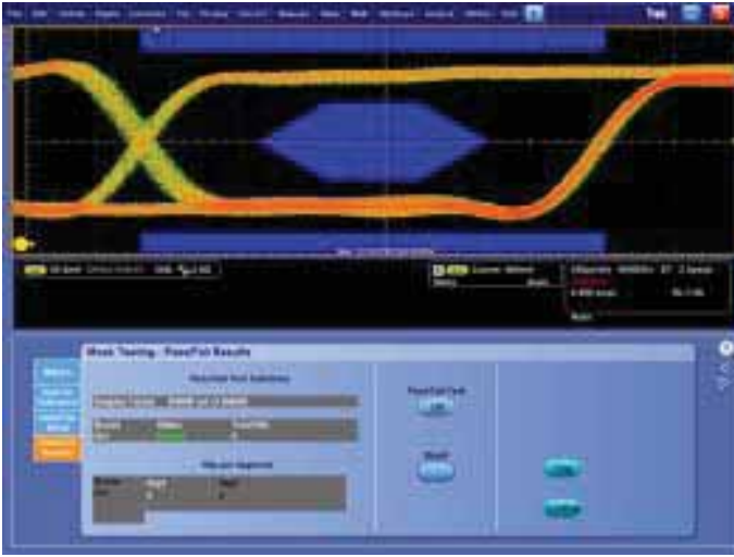
OC-12 訊號遮罩測試擷取所有遮罩的違反。
