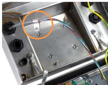
4. 固定接地线夹。对于 IND231，可将接地线夹固定于前盖上的金属安装板上；对于 IND236，可将接地线夹固定于后盖的接地柱上。
