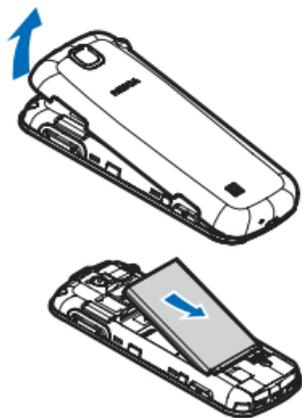
4. 将后盖对准设备上的槽位，然后向下按侧面卡扣，使后盖牢牢锁定。
