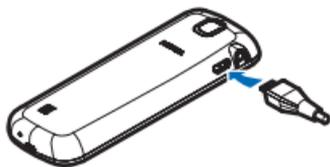
为电池充电时，您不必遵循固定的充电时长，并且可以在充电过程中使用设备。如果电池电量已完全耗尽，则可能需要等待几分钟才可以拨打和接听电话。
