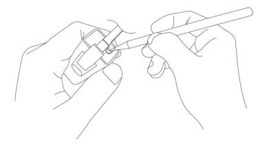
3. 在重置的过程中, 蓝色 LED 一开始会维持恒亮状态约 10 秒, 接着转为闪烁状态约 10 秒, 当蓝色 LED 再次转为恒亮状态, 即表示您的 BR-6258nL 已完成重置作业。
