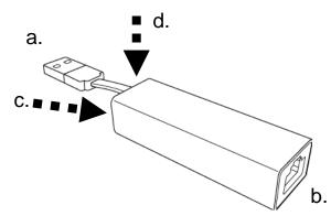
a. USB 连接线: 您可以将此 USB 连接线插入计算机的 USB 端口或者 USB 电源变 压器(如手机随附的电源变压器)
