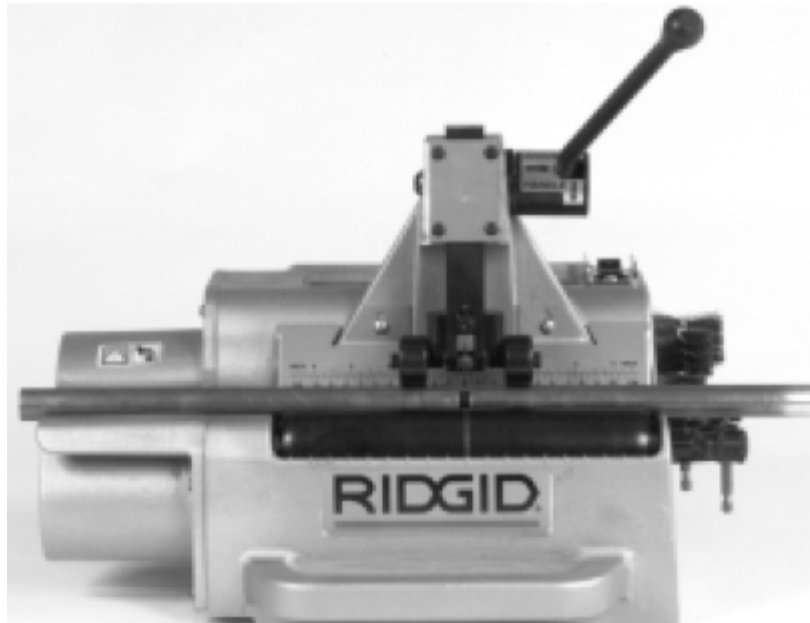
图6 — 割刀两边的支撑轮在切割完成后，还和管子保持接触
