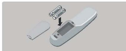
放入R6型号的两节电池(随机提供)，确保方向正确。
