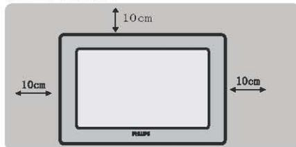
将电视机放置在一个坚固平稳的位置，在电视机周围留出至少10厘米的空间。
