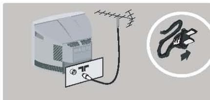
把天线插头插入电视机后面的ANTENNA插座中。如果您使用的是室内天线，在某些情况下，接收效果可能不佳。您可转动天线改善接收效果。如果接收效果仍不佳，您应使用室外天线。
