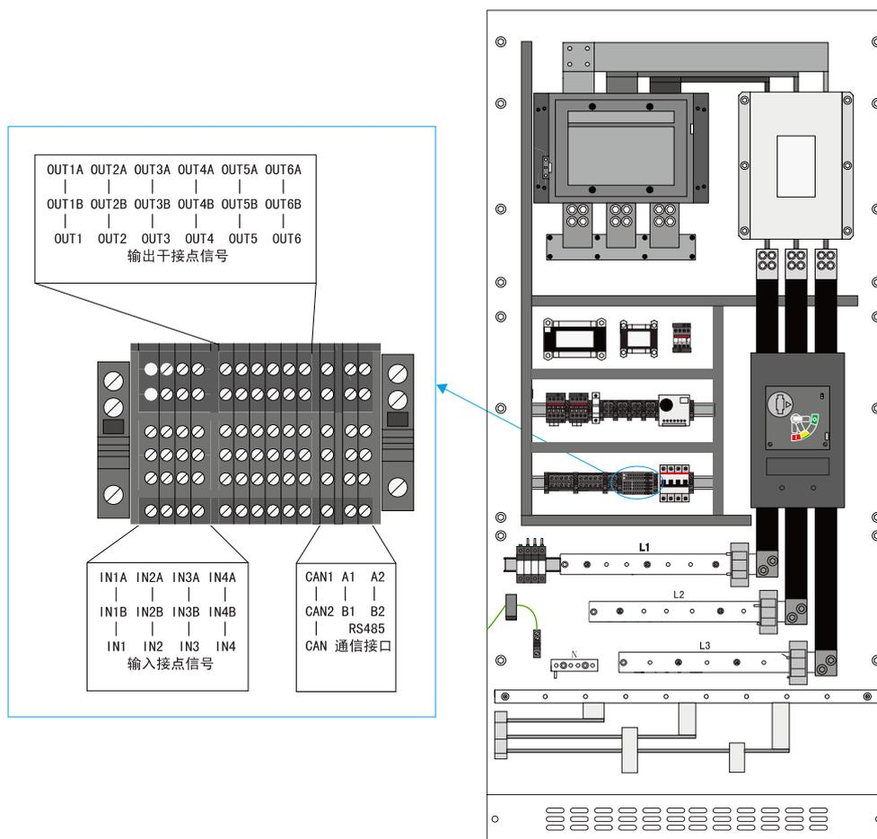
图8-8 通讯系统接线图
