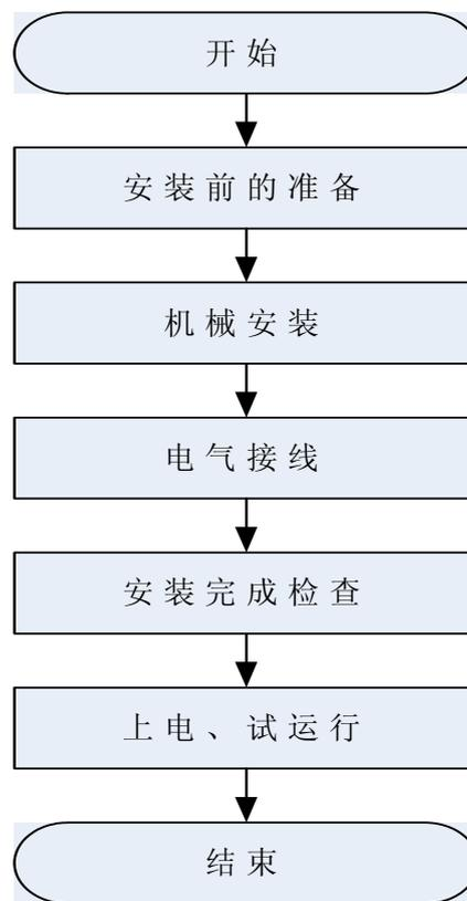
图5-4 安装流程
