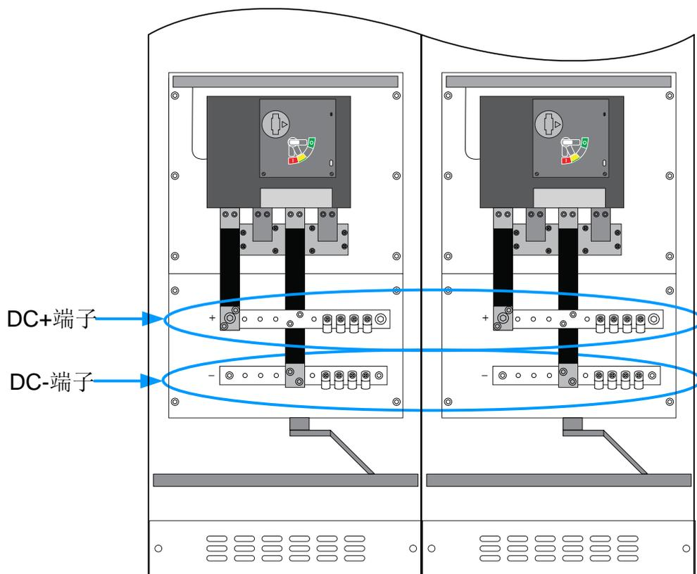
图8-5 直流侧接线端子(图片仅供参考，具体请以实物为准)
