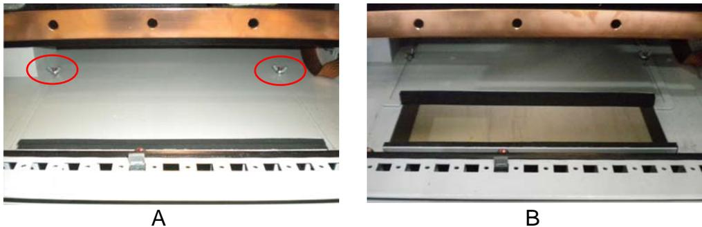
图8-4 底部接线孔
