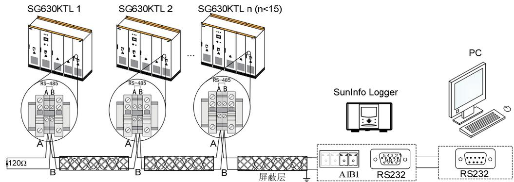
图8-11 数据采集器和 PC 机通过 RS485 进行监控
