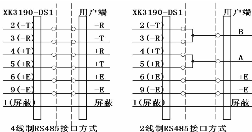
(图 2-4) 4 线制 RS485 和 2 线制 RS485 接口方式
