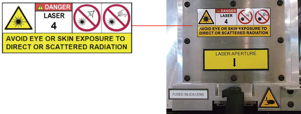
激光安全标签 - 位于扫描仪头部准直器旁侧
