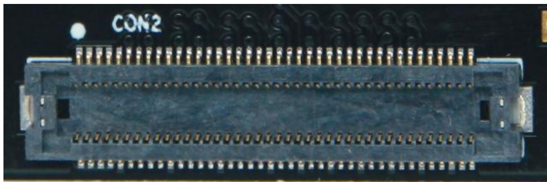
图 2-9-2 CON2 扩展口连接器的实物图
