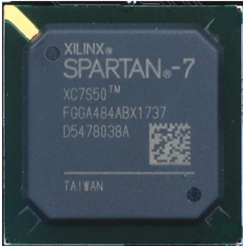
图 2-2-1 FPGA 芯片实物
