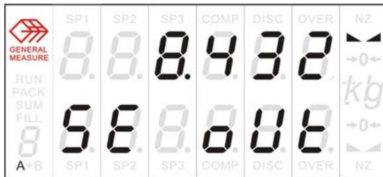
此时按 键可清零当前毫伏数显示（清零当前毫伏数主要用于测试传感器的线性度，不是标定过程中必需的，参考本节结尾处：传感器线性度检测），按
