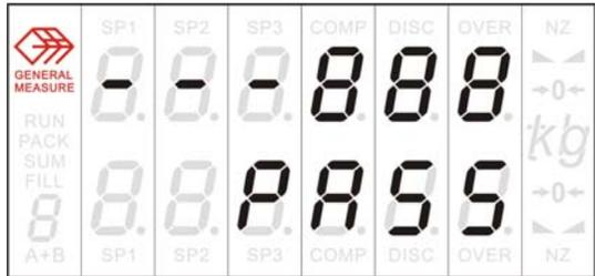
如果密码不正确仪表将返回密码输入状态，但显示“-”变为“**二**”表示此为第二次输入密码。同样，准备第三次输入密码时仪表显示“**三**”。如右图所示。三次输入密码错误，仪表显示 **ERROR4** 并进入自锁状态，此时即使输入正确密码也不会进入标定状态，只有仪表重新上电方可再次进入标定。
