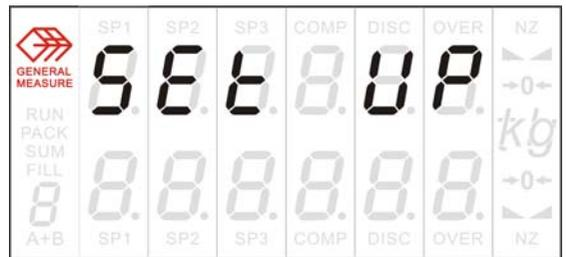
在整个设置过程中，上排显示为实际参数值，下排显示为参数代号
