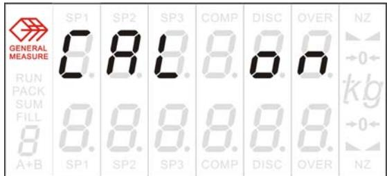
两秒钟后进入标定状态，标定时，上排显示显示标定具体参数内容，下排显示为参数名称提示。
