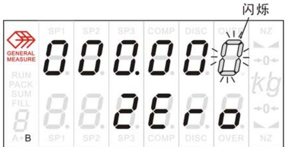
键，即将输入的毫伏数标定为零点，进行下一步。
