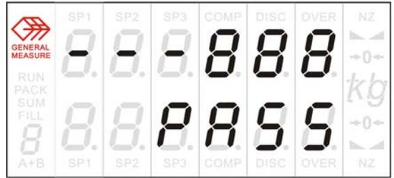
如果密码不正确仪表将返回密码输入状态，但上排显示“-”变为“二”表示此为第二次输入密码。同样，准备第三次输入密码时仪表显示“三”。如右图所示。三次输入密码错误，仪表上显示 **ERROR4** 并进入自锁状态，只有仪表重新上电方可再次进入工作参数设置。
