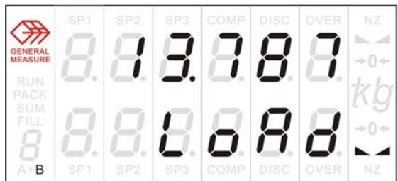
请记录本处的毫伏数及砝码的重量值，以备今后作为应急的无砝码标定。可在下表中填入作为备份：
