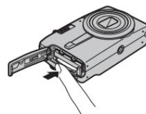
将存储卡接入插槽，然后慢慢放开手指。锁定装置松开，然后存储卡弹出。
