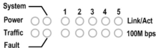
图 2-9 系统指示灯——HiPER 4510NB/3310NB/3300NBs
