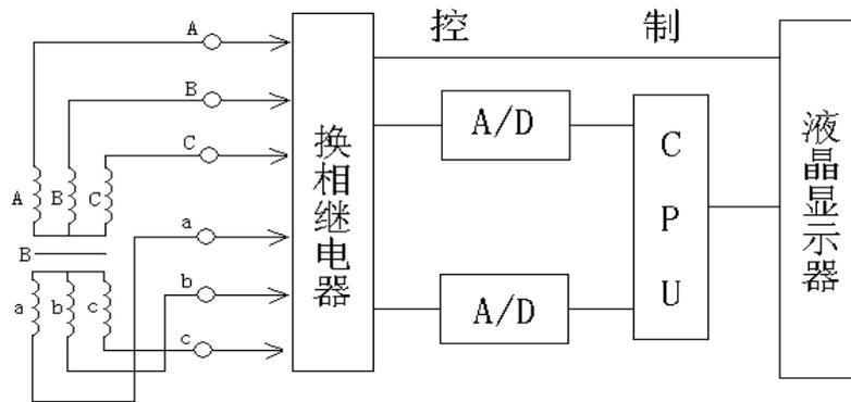
图一 三相变压器、电压互感器测试原理方框图
