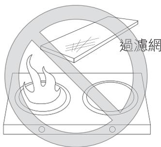
必須使用過濾網。如果不使用過濾網，熱交換引擎被灰塵和髒物堵塞，性能就會降低，甚至不能使用。
