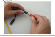
3. 将12V电源适配器的电源输出 头插入显微镜电源输入口
