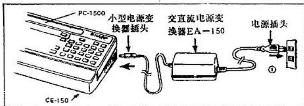
图 3、如何连接交直流电源变换器
