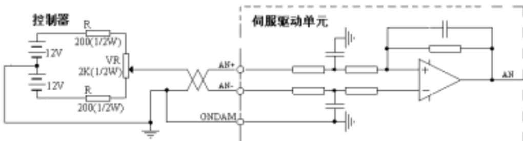
图 5.15.c 模拟差分电位器输入接口
