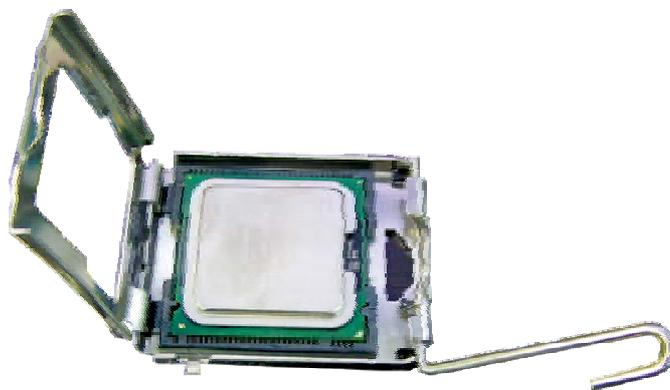
10. CPU 置放妥当后，将固定盖往下推盖住 CPU。
