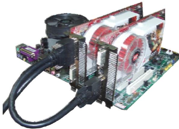
10. 将辅助电源由电源供应器接入显卡。
