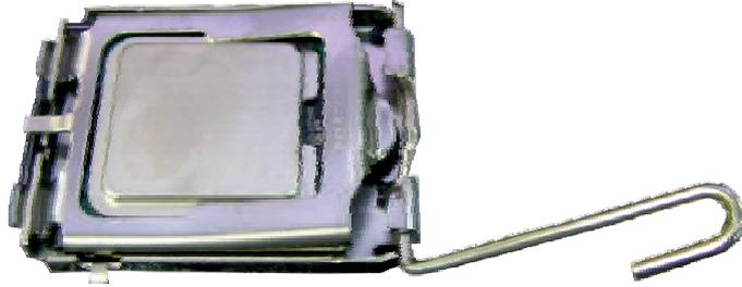
11. 将固定杆推下，卡进脚座侧边的卡榫，以确保 CPU 已牢固地安装于脚座上。
