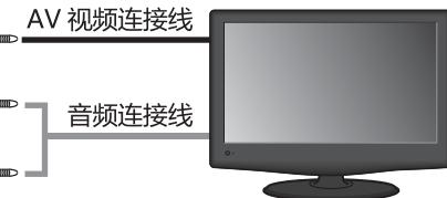
3 连接带 S 视频输出端口的设备
