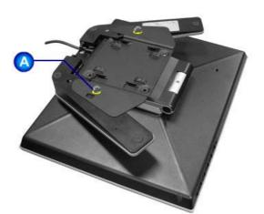
折叠基座并将固定支架放入其中。将固定接口孔与基座 A 上的孔对齐,再用 2 个螺钉固定。
