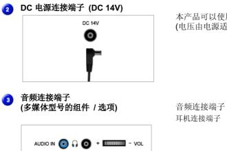
本产品可以使用 90~264VAC 电源。 (电压由电源适配器自动调节。)
