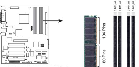
SK8V 184-Pin DDR DIMM Sockets
