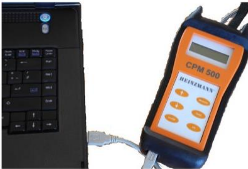
图 5. CPM500USB 数据线连接到电脑
