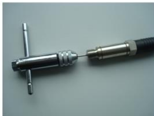
图26专用钻头工具在传感器气道内
