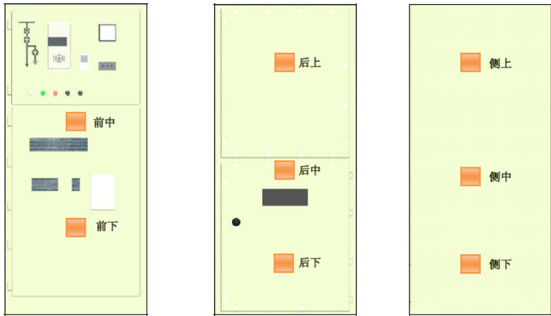
图 6-1 TEV 检测部位示意图
