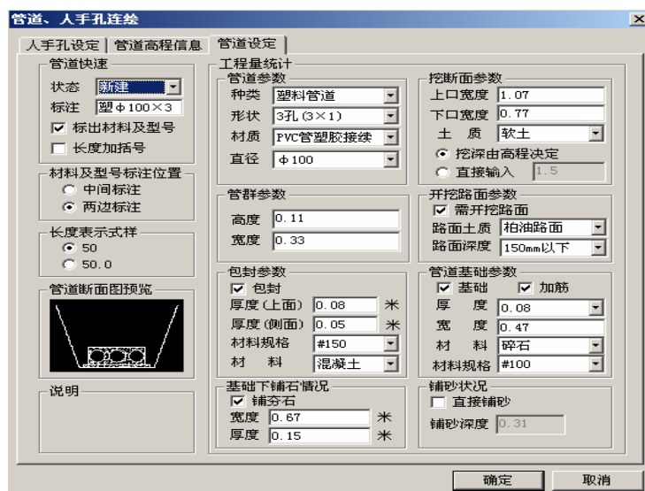
图 (4-1c) 人手孔管道连绘——管道设定
