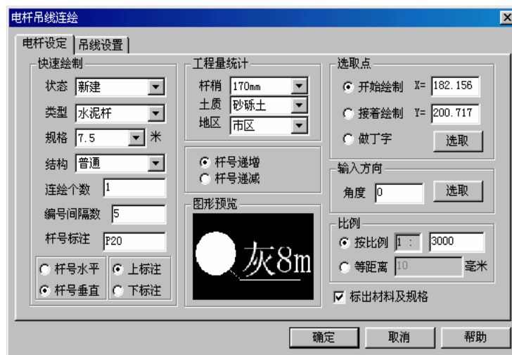
图 (5-1a) 杆路连绘电杆设置
