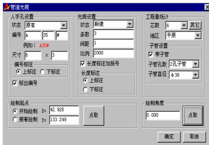
图（6-10）绘制管道光缆
