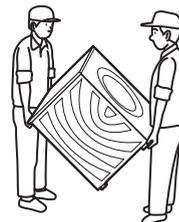
先将洗衣机向后倾斜，一个人站在洗衣机后面握住顶板的突出部，另一个人在前面抓住底部机脚。
