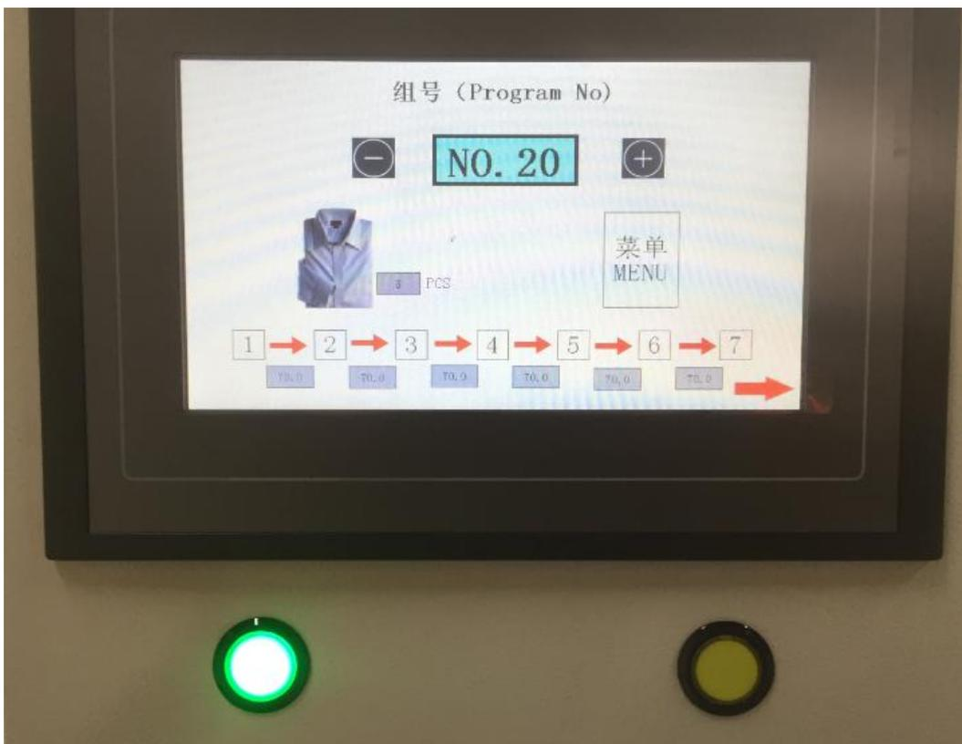
开机后，触摸屏下方的绿色原点复位按钮处于闪烁状态，按下后，完成自动化装置的原点复位按钮复位操作，按钮变成常亮状态，如上图。
