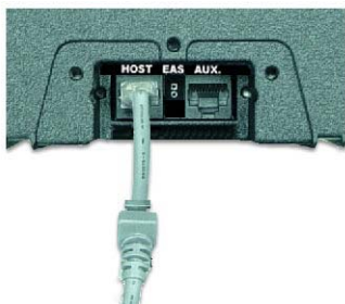
图 3 连接数据线至激光平台
