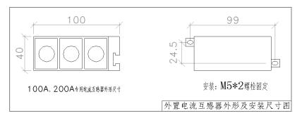
注意上面的安装开孔尺寸已经考虑了安装孔与装置的公差配合,不需要再进行放大。 保护装置的安装方式为嵌入式,装置安装卡与装置一体化,无须任何安装附件和工具,仅 需按尺寸开孔即可。
