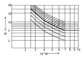
马达 tE 时间最小值与堵转电流比 IA/IN 的关系如图所示。
