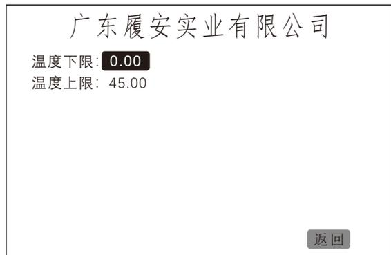
旋转编码器，将光标调整到需要设置参数位置，短按编码器，光标闪烁，则可通过旋转编码器调整上下限阈值；调整完毕短按编码器确认；再通过旋转编码器将光标调整到下一个需要设置的参数位置进行设置，设置方法同前，所有参数设置完毕后，通过编码器将光标调整到“返回”按钮，短按编码器，显示屏将返回到设置界面；
