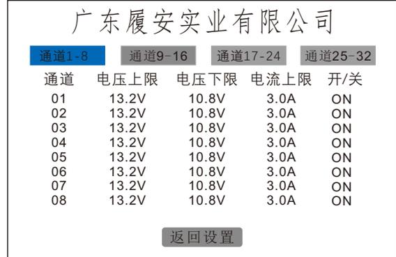
旋转编码器，光标轮流在“通道1-8”“通道9-16”“通道17-24”“通道25-32”和“返回设置”5个按钮之间切换。光标选定所需设置通道后，长按（3秒以上）编码器，进入页面第一个通道第一个参数设置，光标选定后，旋转编码器调整数值，短按进入下一个数值设置。旋转编码器调整数值或状态，短按进入下一个设置项，以此类推；当前页面所需参数设置完毕后，长按编码器，光标返回到通道设置主界面，通过旋转编码器选择其他通道页面进行设置；所有参数设置完毕后，长按编码器，将光标返回到通道设置主界面，通过编码器将光标调整到“返回设置”按钮，长按（3秒以上）编码器，显示屏将返回到设置界面；
