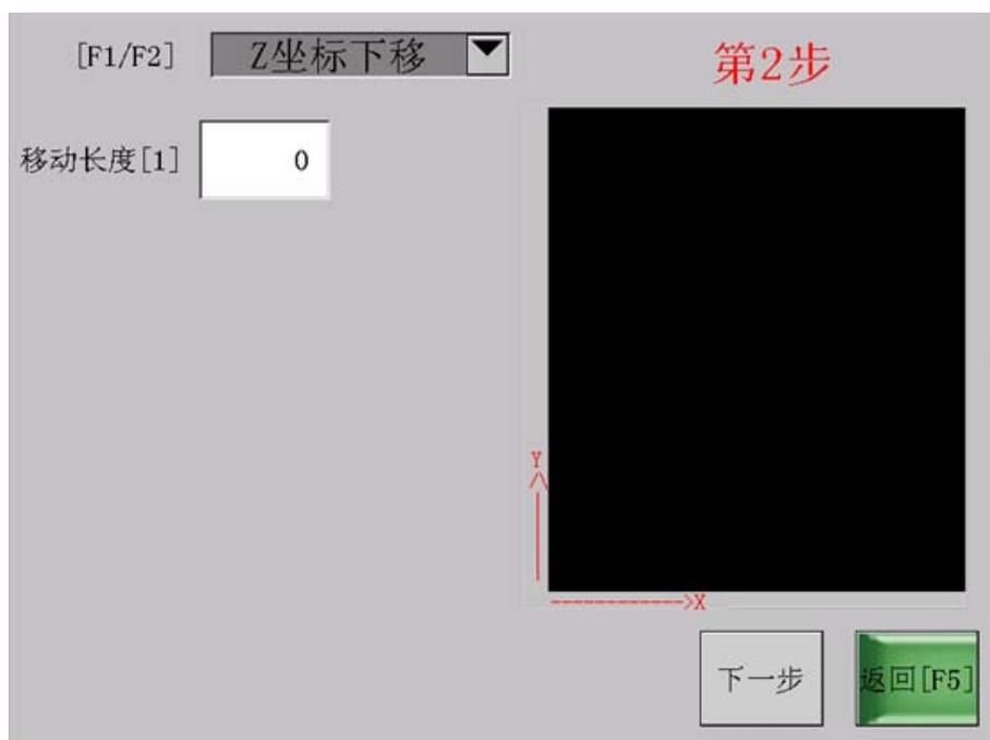
编辑过程中，可通过手动来移动各轴，确定各个点的坐标，从而更方便准确的编写指令。
