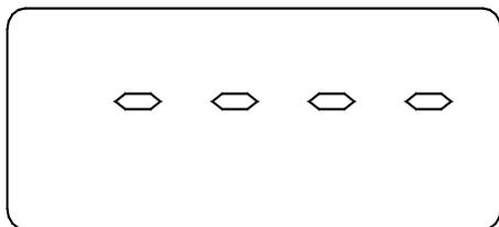
在随机试块上涂耦合剂，将探头与随机试块耦合，屏幕显示的横线将逐条消失，直到屏幕显示 4.00mm 即校准完毕。然后转入测量状态，测量随机试块，若示值误差超出仪器的测量误差还需再次进行校准，直到示值误差在测量误差范围内为止。
