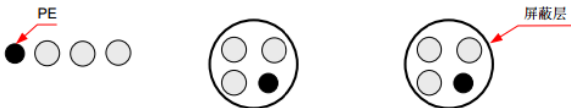
图 3-6 不推荐动力电缆图
