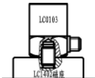
图 6 磁力安装座安装示意图
