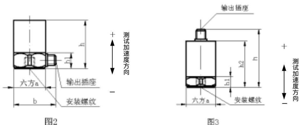
传感器的安装主要有四种方法：螺钉安装、磁力安装座安装、胶粘剂粘接、探针安装。每种安装方式对高频都有影响。螺钉安装频率响应范围最宽，而且是四种安装方法中最安全可靠的一种。其它三种安装方式都减小了高频响应范围。通过在传感器与安装表面间插入安装介质（如：磁力安装座、探针、胶粘剂），一个安装谐振频率就产生了，这个安装谐振频率小于传感器的固有频率，降低了高频范围。传感器离测试点越远，安装谐振频率越低，可用的频率范围越低。
