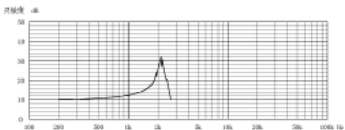
图 11 探针安装频响曲线图
