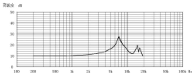
图 7 磁力安装座安装频响曲线图
