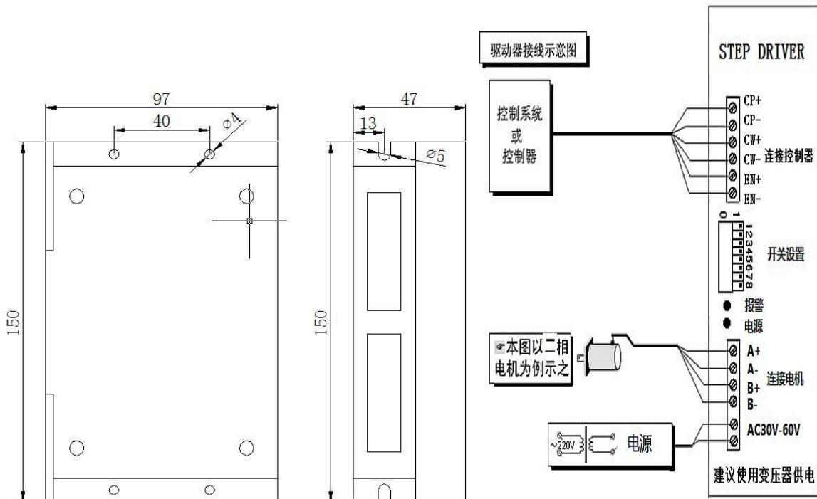
本驱动器是用驱动器上拨盘开关来设定细分数及相电流的,根据标牌的标注设定即可;请您在控制器频率允许的情况下,尽量选用高细分数这样电机运行更加平稳;具体设置方法请参考下表(ON=0,OFF=1):
