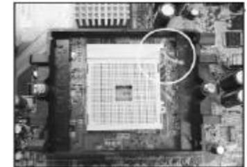
步骤二、在开始安装CPU前，请先检查CPU接触的灵敏触点是否有毁损，避免因针脚短路而造成CPU损坏。(注意不要用手指或者其他硬物体接触插座上与CPU接触的灵敏触点，以免触点受损。)安装CPU时，请注意务必将CPU三角形缺口Pin1处对准主机上之相应白漆地方后，再放入CPU。
