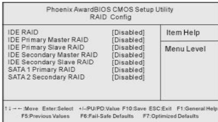
在以上 BIOS 设置画面，要作磁盘阵列，首先将“IDE RAID”项设为 Enabled，再将要作磁盘阵列的硬盘设为 Enabled，其它作为普通硬盘使用的设为 Disabled，然后按“F10”键保存退出。
