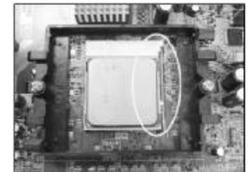
步骤四、按照右图箭头的方向压下固定夹，将CPU风扇固定在CPU脚座上。（安装风扇散热片前务必涂上散热膏）
