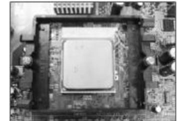
步骤三、确定处理器是紧紧扣在CPU的插座中，然后将拉杆放下紧紧地扣在CPU脚座侧边的固定位置上。
