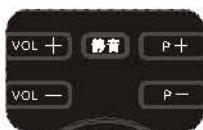
按下遥控器上的节目增减键即可切换频道（音量的增减请按音量增减键）
