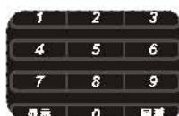
按下遥控器上的数字键即可直接选择频道（默认三位输入方式）
