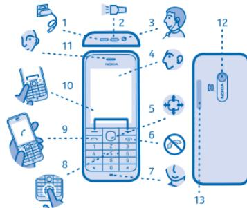
当天线正处于使用状态时，请勿接触天线区域。接触天线会影响通信的质量，同时由于设备在电量级别较高的状态下工作，因此可能缩短电池的寿命。
