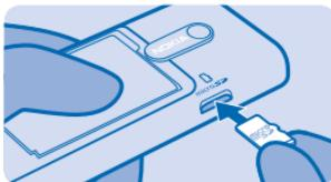
**!** **重要须知：**请勿在应用程序使用存储卡的过程中取出存储卡。这样做不仅可能损坏存储卡和设备，还可能破坏卡内储存的数据。
