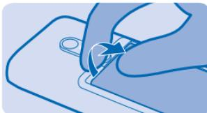
**4.** 使 SIM 卡触点朝下，将 SIM 卡滑入卡夹。要插入第二张 SIM 卡，请将其滑入另一个卡夹。
