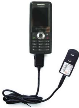
充电完成后断开交流电源插座，然后按住充电器接口两边的按钮，把充电器从手机底部拔出，从而断开手机与充电器相互间的连接。
