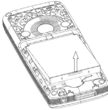
**警告：**拆卸电池之前一定要将手机关机。绝对禁止在开机的情况下直接取出电池，否则可能损坏 SIM 卡和手机。
