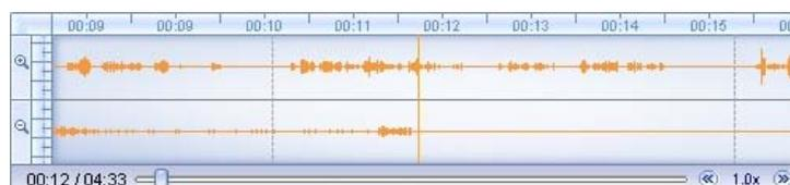
其中上下兩根波形，分別顯示原音和錄音的波形；左邊放大、縮小按鈕，可對兩根波形的幅度進行放大、縮小。最小方為播放進度和原音的長度。
