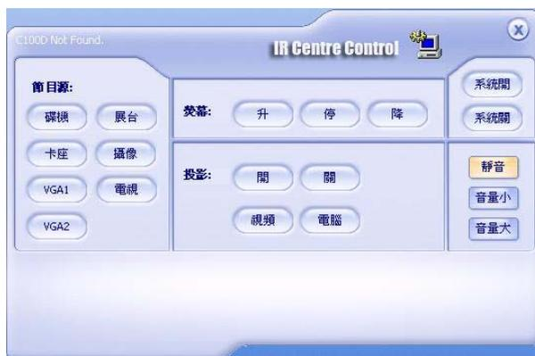
通過快捷鍵 Ctrl+U 或聲音輸入選擇區的紅外線控制面板面按鈕可以啓動中控制面板面。在 Infinity DLL 程式中可通過電教中控面板控制外設。節目源的選擇是指當前輸入的節目來源，隨著節目源不同，可以進行的控制也有所區別。
