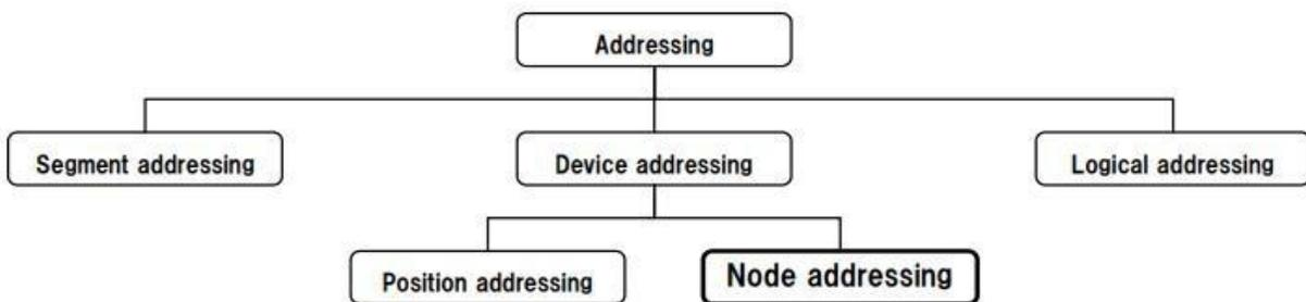
EtherCAT 对于设备的寻址包含位置寻址和节点寻址。位置寻址由主站根据从站设备的连接顺序分配, 节点寻址则可以由从站自行分配节点地址, 主站可以根据节点地址来寻找特定的节点。
