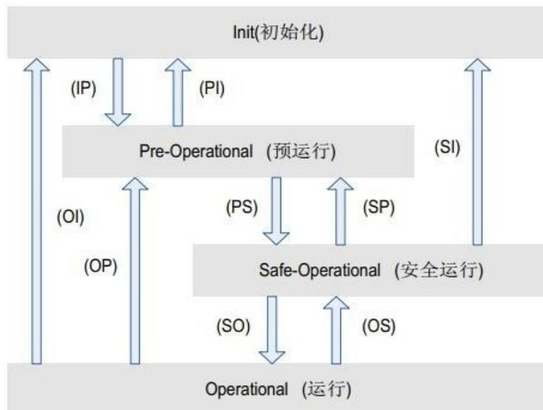
图3-1 节点状态转移图
