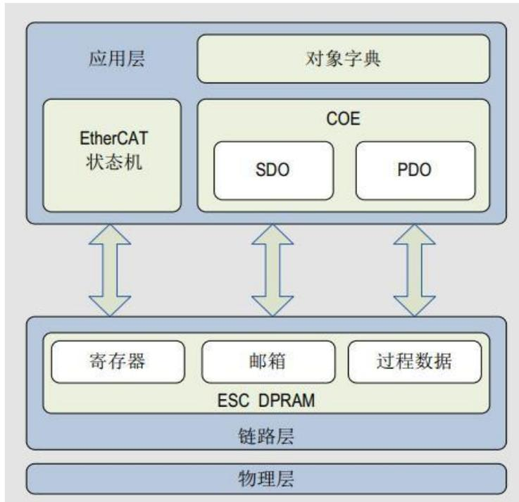
结构图中，在应用层对象字典里包含了：通信参数、应用程序数据，以及 PDO 的映射数据等。PDO 过程数据对象，包含了伺服驱动器运行过程中的实时数据，且会周期性地读写访问。SDO 邮箱通信，则以非周期性的对一些通信参数对象、PDO 过程数据对象，进行访问修改。
