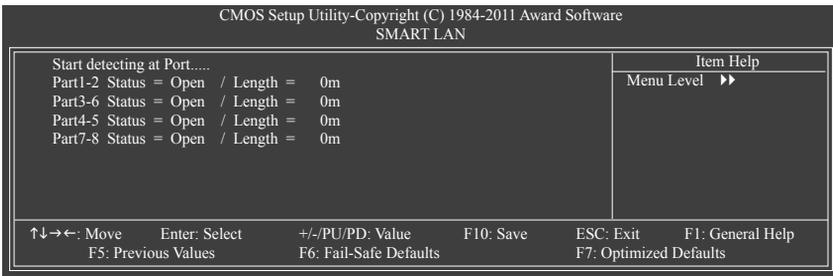
이 메인보드에는 연결된 LAN 케이블의 상태를 감지하도록 고안된 케이블 진단 기능이 포함되어 있습니다. 이 기능은 케이블 배선 문제를 감지하고 장애나 단락까지의 대략의 거리를 보고합니다. LAN 케이블 진단에 대한 다음 정보를 참조하십시오:
