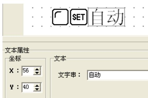
以同样方法设置手动按键, 手动状态指示灯。指示灯的地址仍然对应 M10, 显示属性取负逻辑。指定按键为“ENT”键, 按键功能为置 M10 继电器 OFF。
