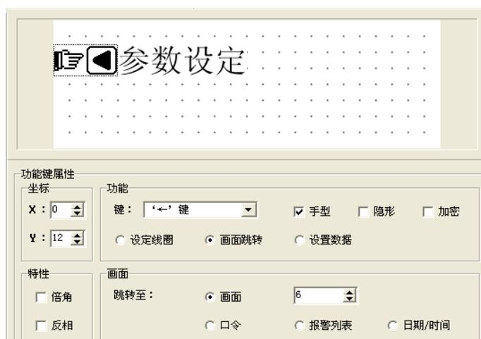
为了隐藏设定画面，置“加密”属性有效，只有当系统口令打开时，才能跳转到 6 号画面。功能键设定之后，在按键图形的右边放置文本“设定参数”，提示操作人员，按下“<”键便能直接进入参数设定画面。
