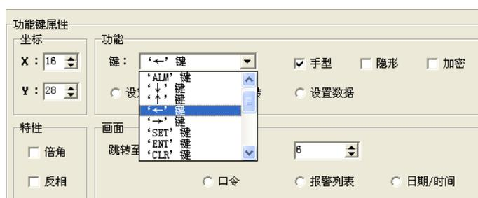
如果为了简明起见，可以取消手形显示，屏幕只显示按键外形。随后将功能设定为画面跳转，此时在其下方设定跳转画面号，将目标画面号设定为 6，即第 6 号画面为参数设定画面。
