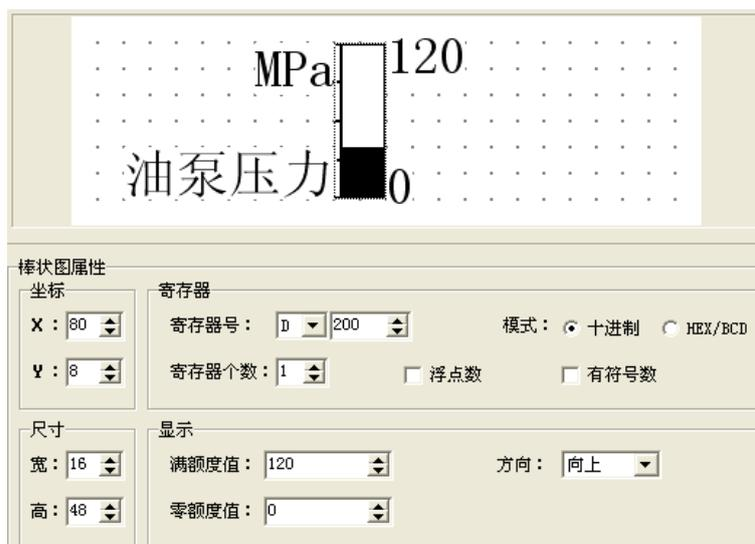
该棒形图监视 D200 中的数据，当棒形图满刻度显示时，表示 D200 中的数据为 120；当棒形图 50% 刻度显示时，表示 D200 中的数据为 60。
