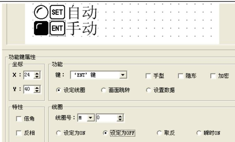
设置 2 个圆形指示灯，正逻辑。地址分别对 M20 和 M21，监视电机的运行状态。当左边指示灯亮时，表示电机正向运转；当右边指示灯亮时，表示电机反向运转。
