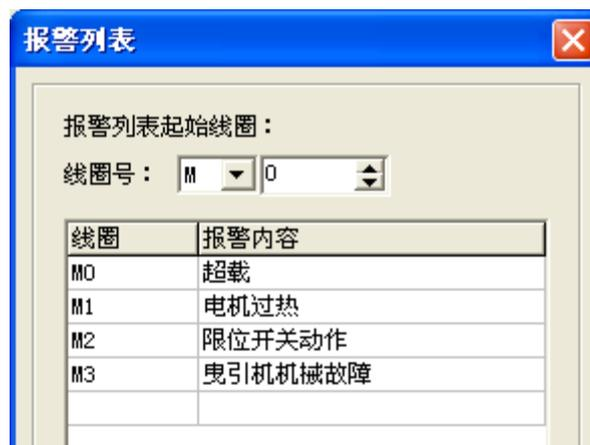
所有报警信息登录之后，可以修改线圈编号，例如将线圈定义号改为 M30，这样 M30-M33 分别对应 4 条报警信息。
