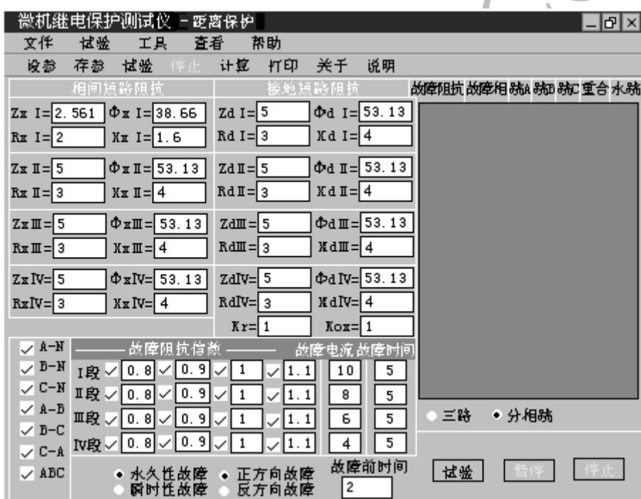
**注意：** 1. 距离保护试验中，所有故障数据全部由计算机完成。计算机根据所设定的故障电流和故障阻抗计算得出的短路电压，每相不得大于正常值  $57.7V$ ，如果过大，则自动降低故障电流值，以满足  $V_f \leq 57.7V$  的条件。
