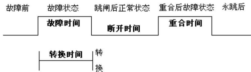
**转换性故障 / 非转换性故障** 用于设置转换性故障。从故障开始时刻起，当转换时间到，无论保护是否动作跳开断路器，均进入转换后故障状态。但跳开相的电压电流不受转换性故障状态影响，其电压  $V=57.7V$  或  $0V$ ， $I=0A$ 。故障转换时间是指从第一故障开始时算起的时间。
