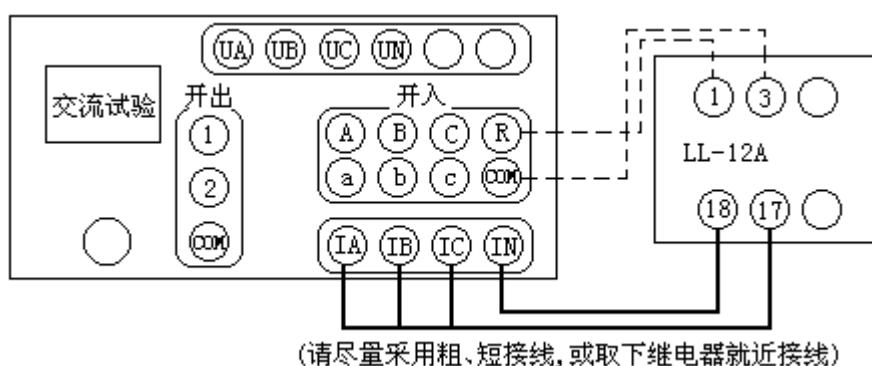
在交流试验中， $U_a$ （或  $U_{ab}$ ）/  $I_a$  设定为某一初值，设置步长，按“▲”、“▼”键或旋动旋钮（亦可
