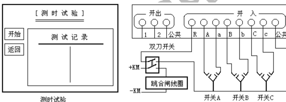
试验时需外加一双刀双掷开关，一个刀用于通断跳合闸电流，另一个刀及 6 路开关触头的辅助接点接入开端进行时间测量。
