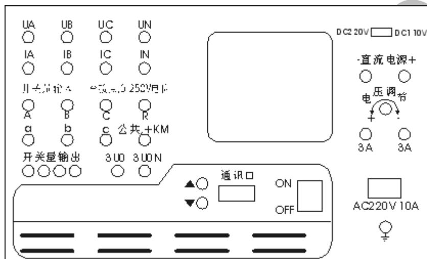
1. UA、UB、UC、UN 三相电压输出端子既可靠输出标准三相交流电压、也可输出三相直流电压，输出交流时，每相输出的相电压幅值、相位角可任意设置，频率可以在 0~1000Hz 设置，幅值、相位角、频率均可按所设置的步长自动或手动递增、递减。也可以叠加各次谐波。各相最大输出相电压为 0~120V、线电压输出如 UA 为 100V 或 120V、 $0^\circ$ , UB 为 100V 或 120V,  $180^\circ$ , 则 UAB=200V 或 240V。
