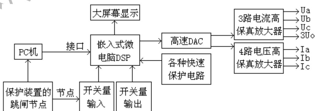
以最新数字信号处理技术 DSP 器件为核心集成于 FPGA 先进技术，采用 16
