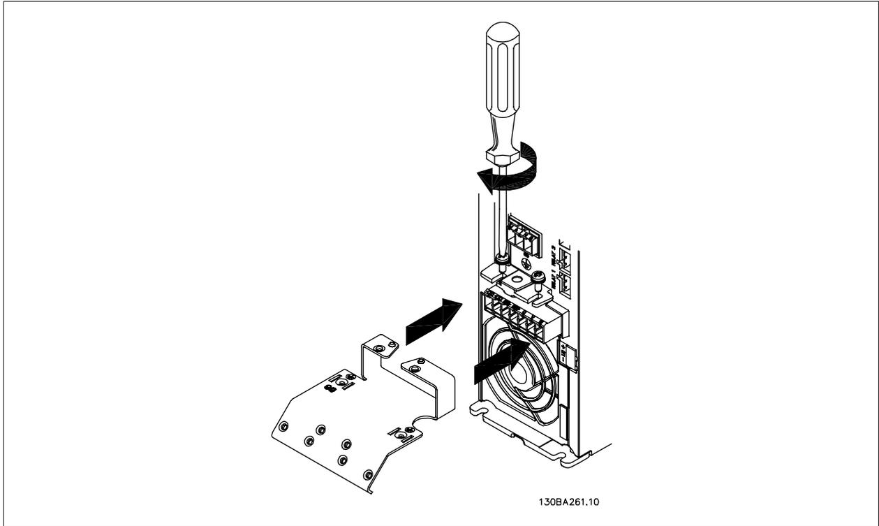
图 4.2: 首先, 将两个螺钉安装到固定板上, 然后将其滑动入位并完全拧紧。
