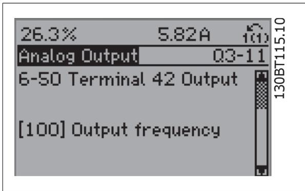
图 6.7: 步骤 6: 选择参数 6-50 端子 42 输出。按 [OK] (确定)。
