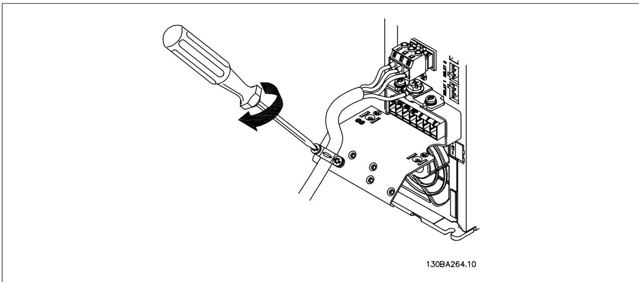
图 4.5: 最后, 拧紧主电源电线的支持架。
