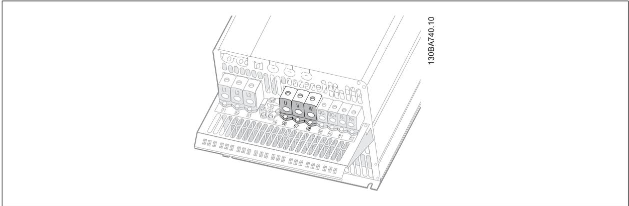
图 4.23: 首先, 断开电动机接地, 然后, 将电动机 U、V 和 W 电线接入端子并拧紧。请确保去除 EMC 电缆夹下面电动机电缆的外部绝缘层。
