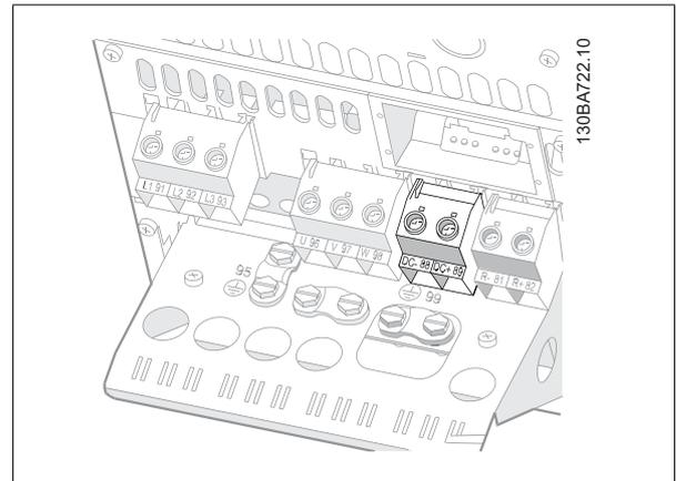
图 4.28: 机箱 B4 的直流总线连接。
