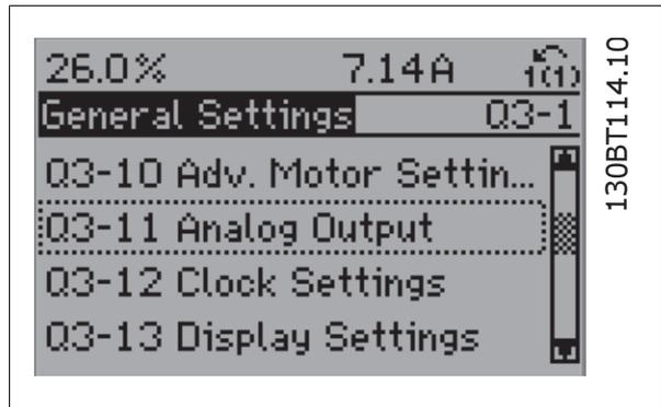
图 6.6: 步骤 5: 使用向上/向下导航键向下滚动到目标选项, 比如 03-11 模拟输出。按 [OK] (确定)。
