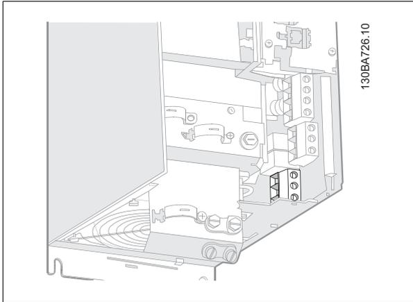
图 4.20: 首先, 断开电动机接地, 然后, 将电动机 U、V 和 W 电线接入端子并拧紧。请确保去除 EMC 电缆夹下面电动机电缆的外部绝缘层。
