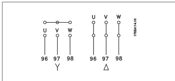
图 4.15: 电动机连接端子
