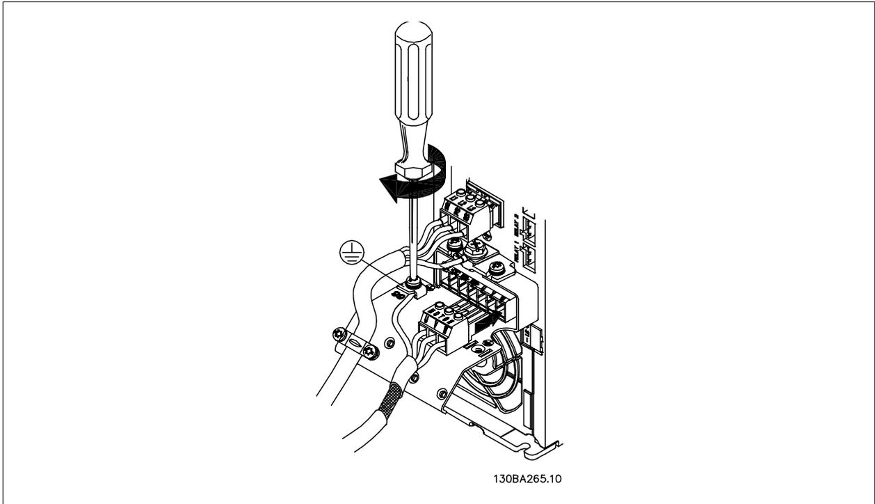
图 4.16: 首先, 断开电动机接地, 然后, 将电动机 U、V 和 W 电线插入插头并拧紧。
