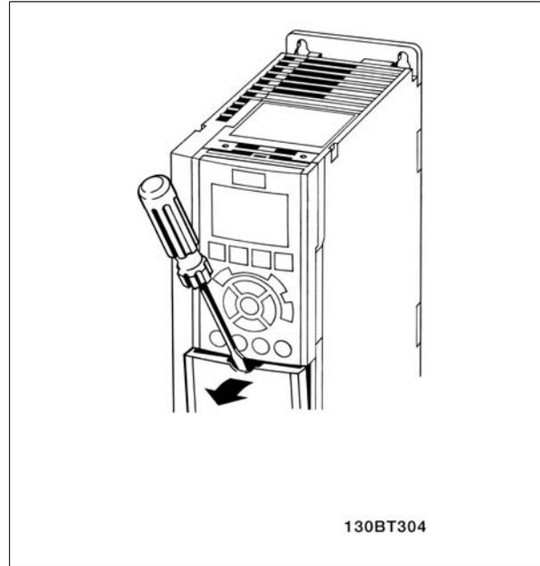
图 4.24: 访问 A2、A3、B3、B4、C3 和 C4 机箱的控制端子
