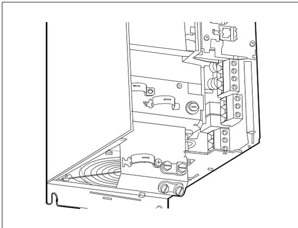
图 4.27: 机箱 B3 的直流总线连接。
