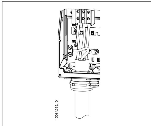
图 4.12: 如何连接 C1 和 C2 的主电源和接地。
