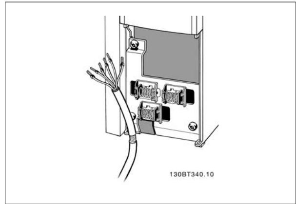
图 4.49: 控制电缆线夹。
