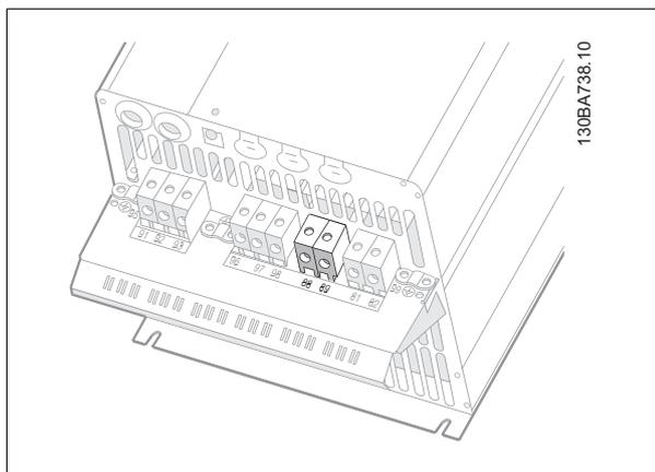
图 4.29: 机箱 C3 的直流总线连接。
