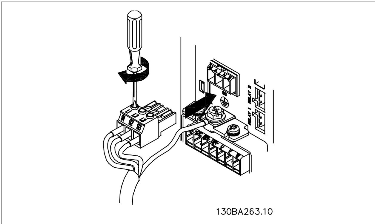
图 4.4: 然后, 安装主电源插头并拧紧电线。
