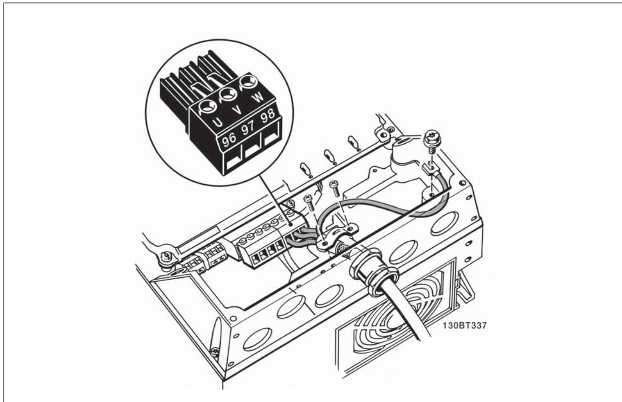
图 4.18: 首先端接电动机地线, 然后将电动机的 U、V 和 W 电线接入端子并拧紧。请确保去除 EMC 电缆夹下面电动机电缆的外部绝缘层。
