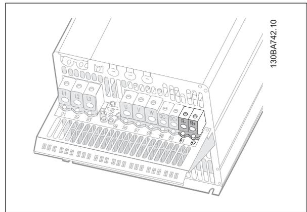
图 4.34: C4 的制动连接端子。
