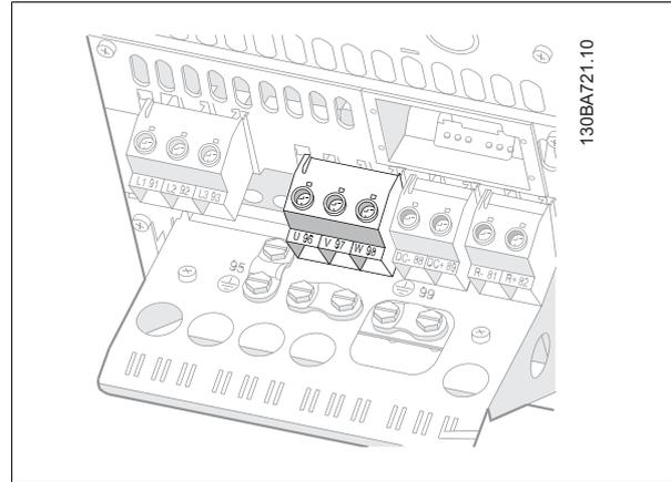
图 4.21: 首先, 断开电动机接地, 然后, 将电动机 U、V 和 W 电线接入端子并拧紧。请确保去除 EMC 电缆夹下面电动机电缆的外部绝缘层。
