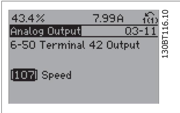
图 6.8: 步骤 7: 使用向上/向下导航键选择不同选项。按 [OK] (确定)。
