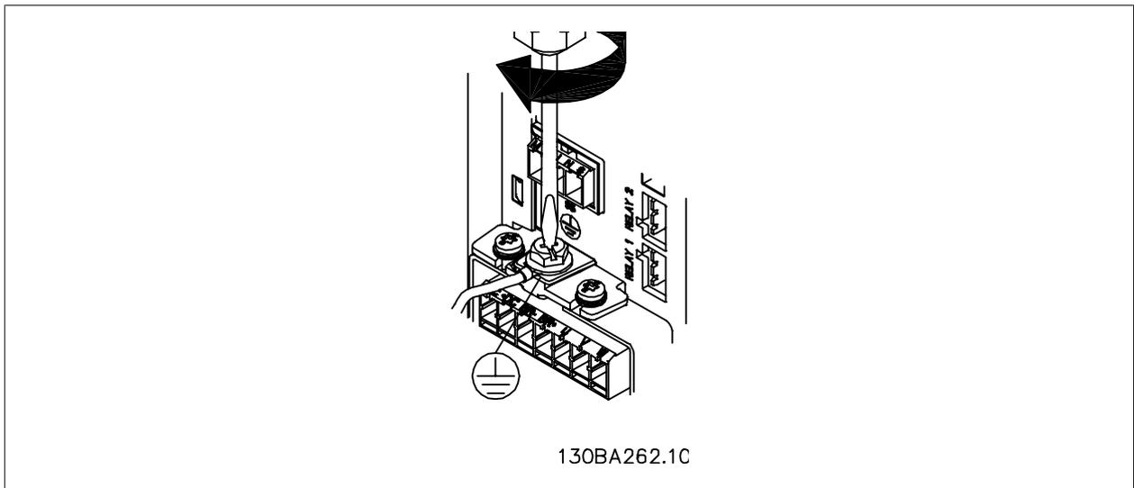
图 4.3: 安装电缆时, 首先安装并拧紧接地电线。
