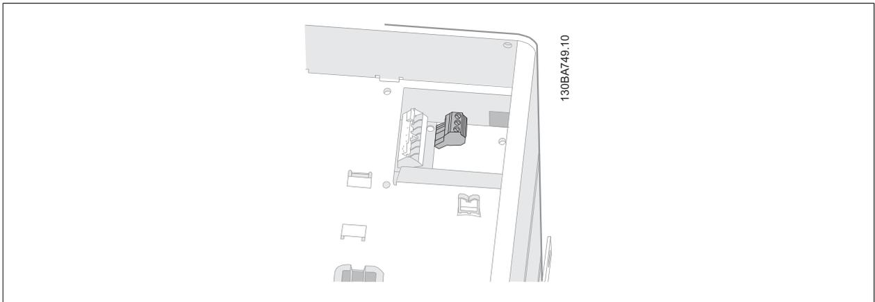
图 4.38: C3 和 C4 的继电器连接端子。位于变频器的右上角。
