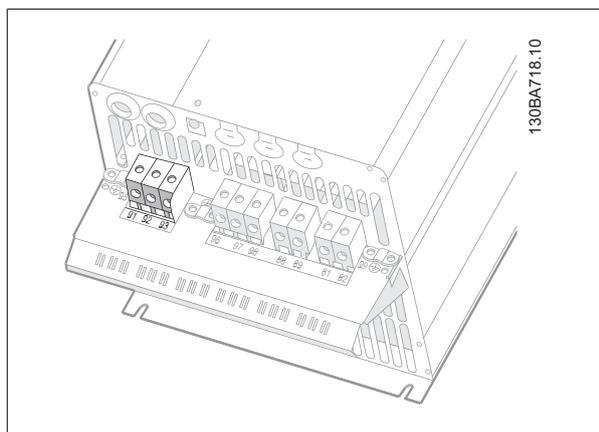
图 4.13: 如何连接 C3 的主电源和接地。
