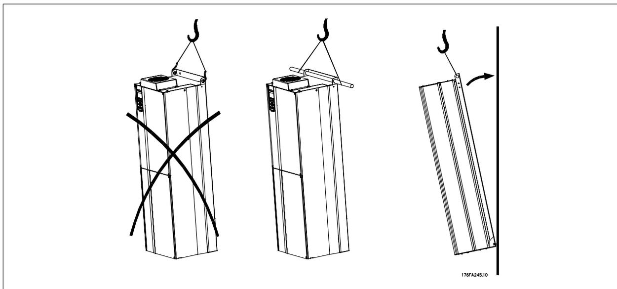
图 3.1: 对于较重的变频器, 请使用提升设备。首先以墙面安装方式安装两个较低的螺栓, 然后将变频器抬起放在这两个较低的螺栓上, 最后使用两个较高的螺栓将变频器靠近墙面拧紧。
