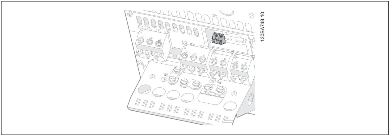
图 4.37: B4 的继电器连接端子。
