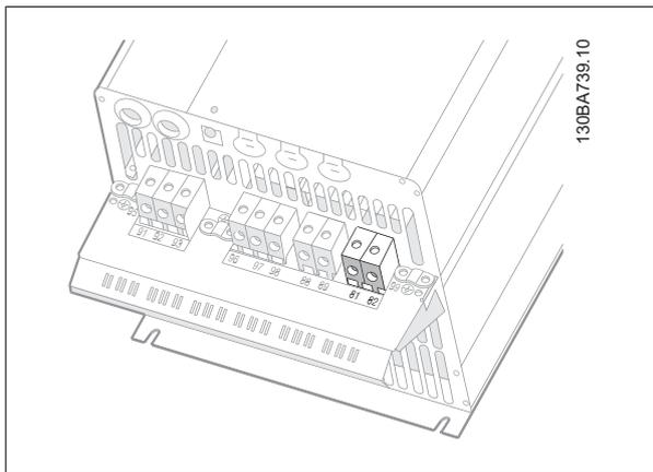
图 4.33: C3 的制动连接端子。
