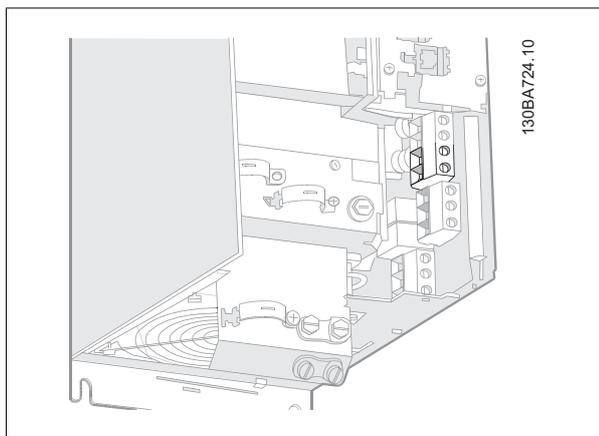
图 4.31: B3 的制动连接端子。
