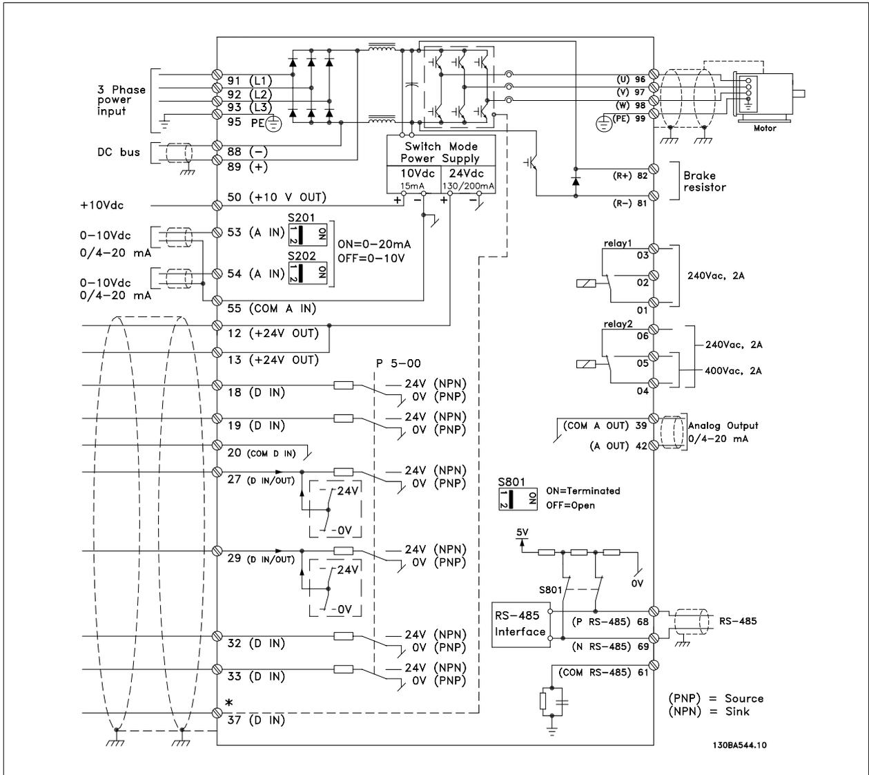
图 4.48: 图示显示了所有电气端子。（仅带有安全停止功能的设备才提供端子 37。）
