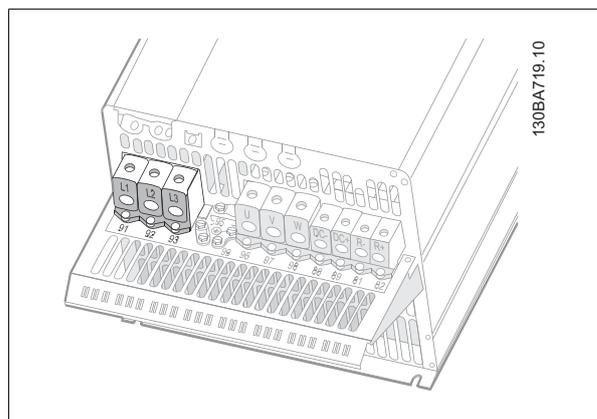
图 4.14: 如何连接 C4 的主电源和接地。
