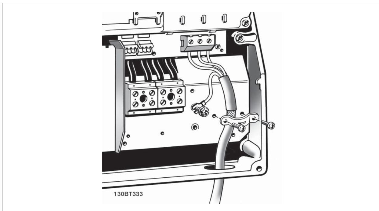
图 4.19: 首先, 断开电动机接地, 然后, 将电动机 U、V 和 W 电线接入端子并拧紧。请确保去除 EMC 电缆夹下面电动机电缆的外部绝缘层。
