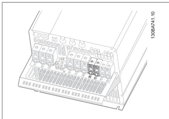
图 4.30: 机箱 C4 的直流总线连接。
