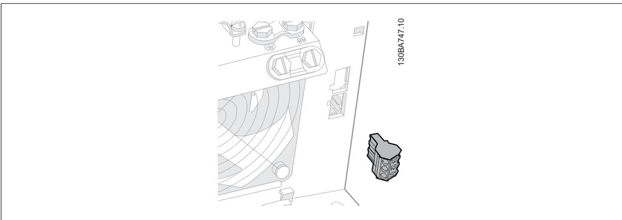
图 4.36: B3 的继电器连接端子。出厂时只由一个挡板。
