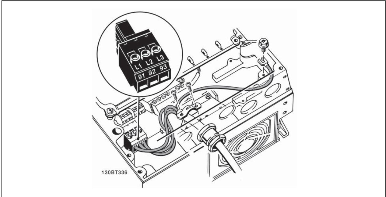
图 4.6: 如何在不用主电源断路开关的情况下连接主电源和接地。注意, 需要使用电缆夹。
