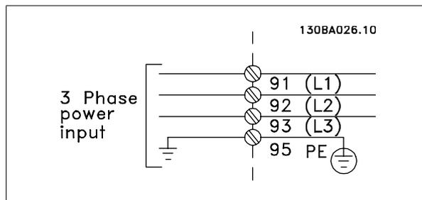
图 4.1: 主电源端子和接地端子。
