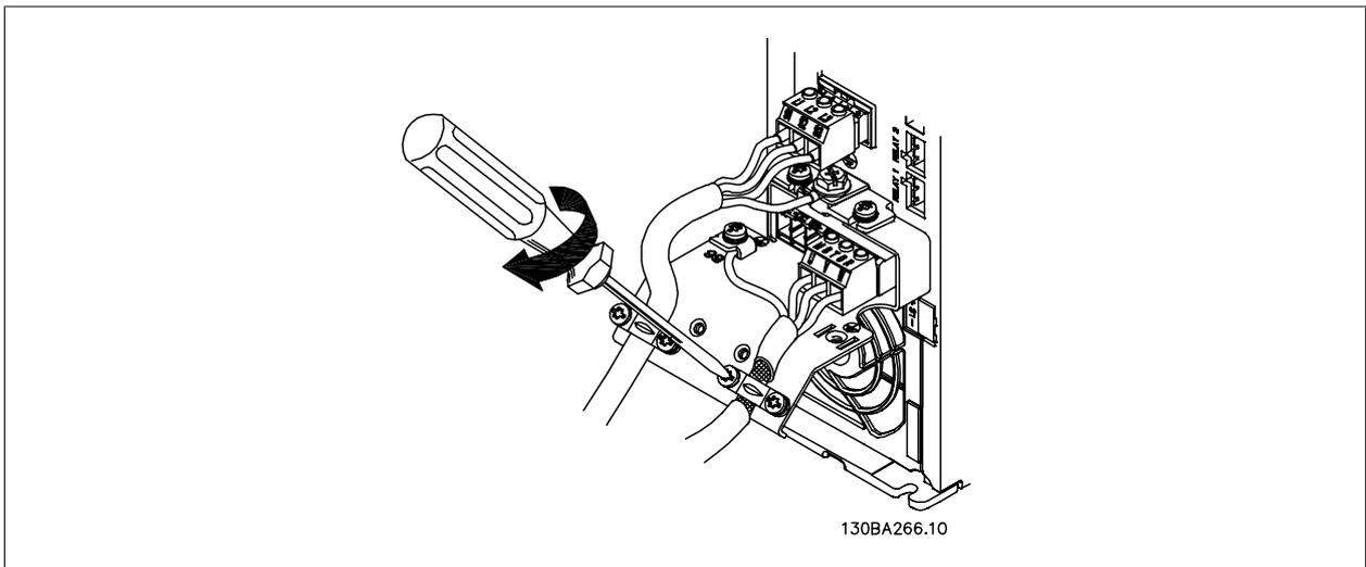
图 4.17: 安装电缆夹, 以确保机架和屏蔽丝网达到 360 度连接。注意, 请去除电缆夹下面电动机电缆的外部绝缘层。
