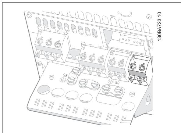
图 4.32: B4 的制动连接端子。
