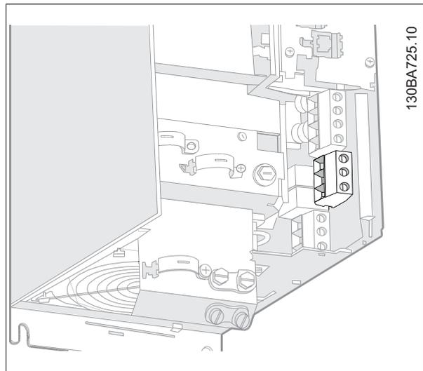
图 4.10: 如何连接不带 RF 的 B3 的主电源和接地。
