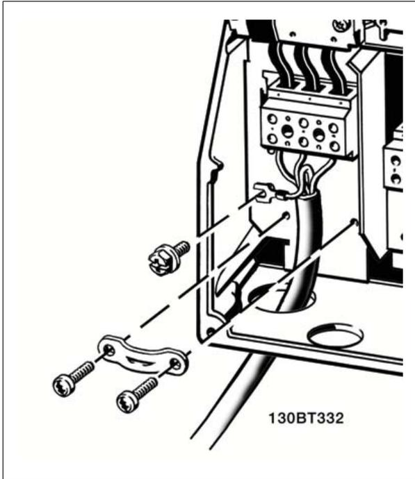
图 4.8: 如何连接 B1 和 B2 的主电源和接地。
