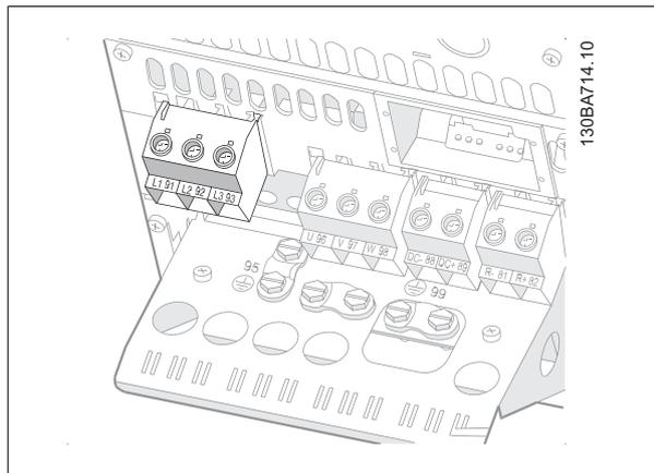
图 4.11: 如何连接 B4 的主电源和接地。
