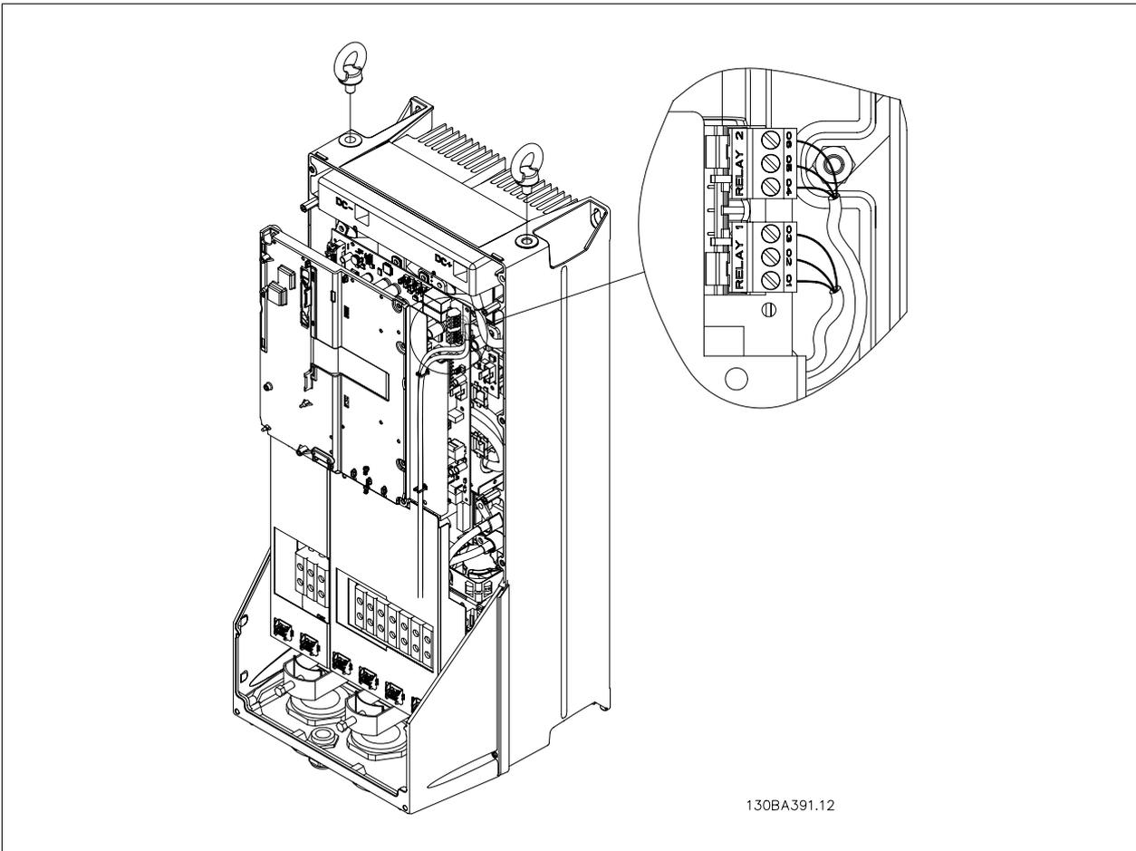
图 4.35: 继电器连接端子 (C1 和 C2 机箱)
