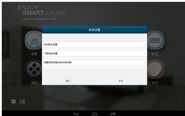
KNX 网关设置，输入网关地址和端口
