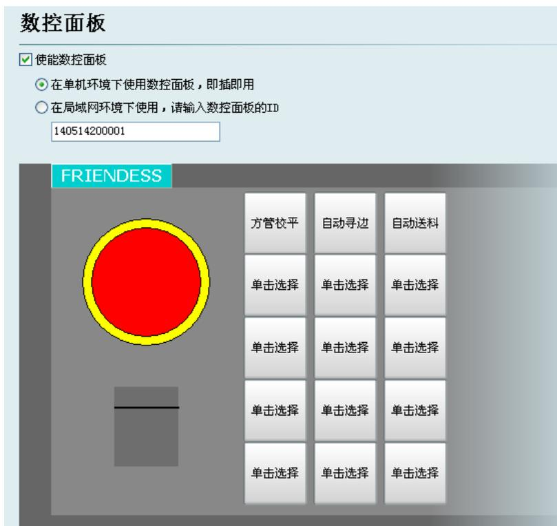
在数控面板界面可激活 BCP5045 数控面板。在单机环境下使用时，CypCut 软件会自适应匹配 BCP5045 数控面板的 Mac 地址，自动连接控制。在局域网环境下使用 BCP5045 时，请输入 BCP5045 的设备 ID 号。BCP5045 共有 12 个自定义按键，可配置为双交换工作台或其他自定义 PLC 的控制按钮。
