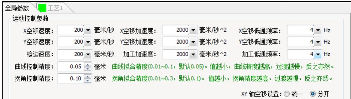
使用单轴运动测试，确定系统的脉冲当量是否设置正确。
