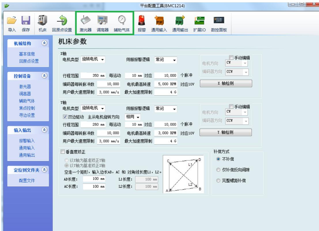
平台配置工具主界面是信息总览；左侧和上方均是进入各种参数设置界面的快捷按钮；如上图所示的绿色框选部分是控制设备中激光器，调高器和辅助气体的快捷按钮。点击左侧的“配置文件”按钮可以定位到 Data 文件夹。
