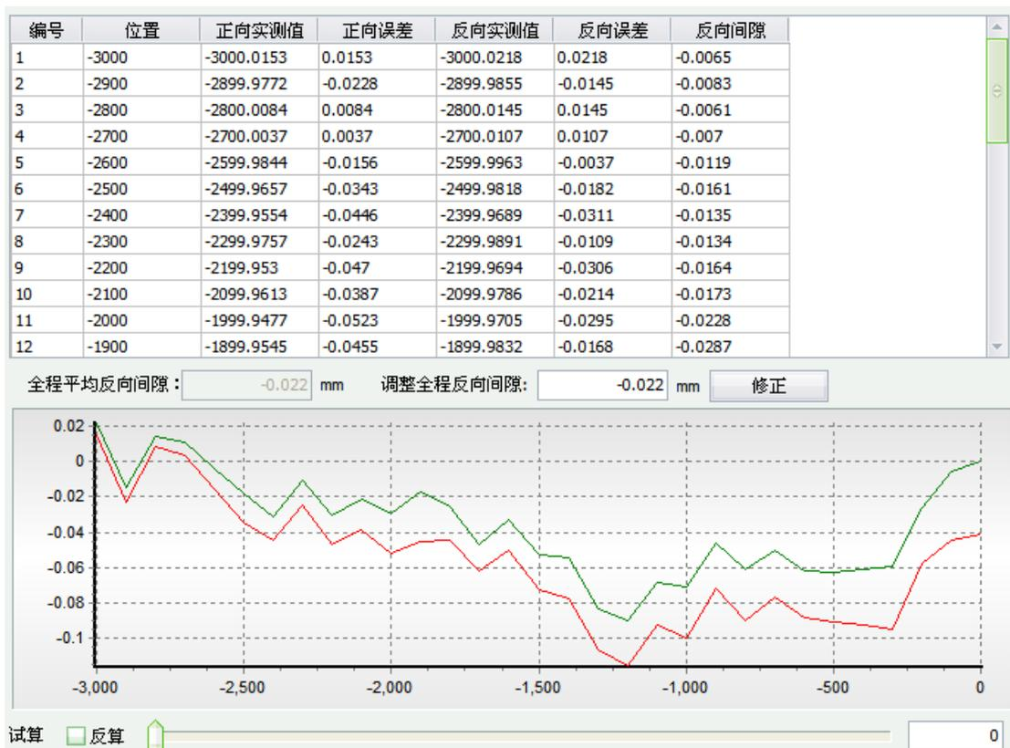
补偿后，最大误差 0.2 毫米，反向间隙 0.048 毫米，曲线形状不变。
