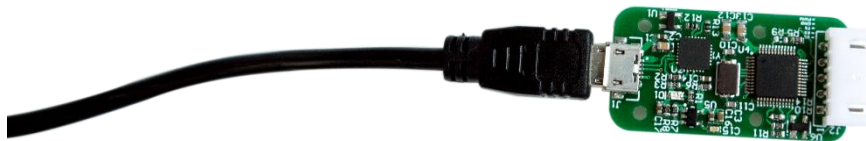
图表 2-2 连接 USB 转换器与 Micro-USB 实物图
