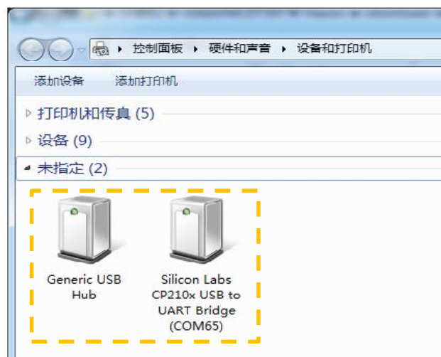
图表 2-5 识别到的 USB 转接器所对应的串口名
